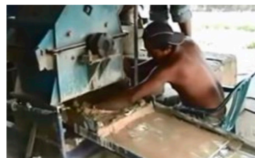
4. Recuperación del oro en planchas de cobre
