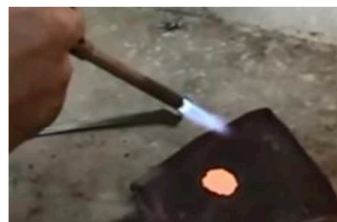
6. Calcinado para la eliminación del mercurio
